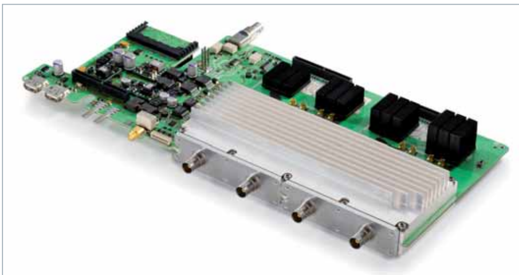
R&S®RTO 前端使用了高性能设计的屏蔽罩，确保通道与通道之间实现可靠的隔离。
