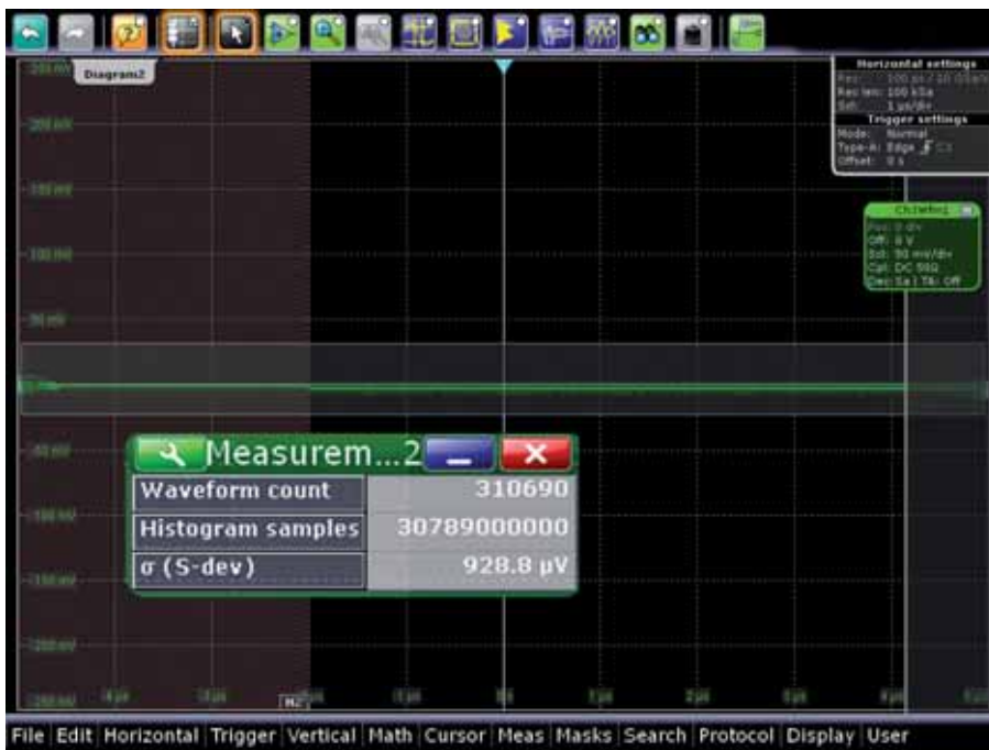
R&S®RTO1024 示波器典型的固有噪声: 直方图测量的标准偏差 (S-dev) 测量条件: 50 mV/div, 分辨率 100 ps, 无滤波器。
