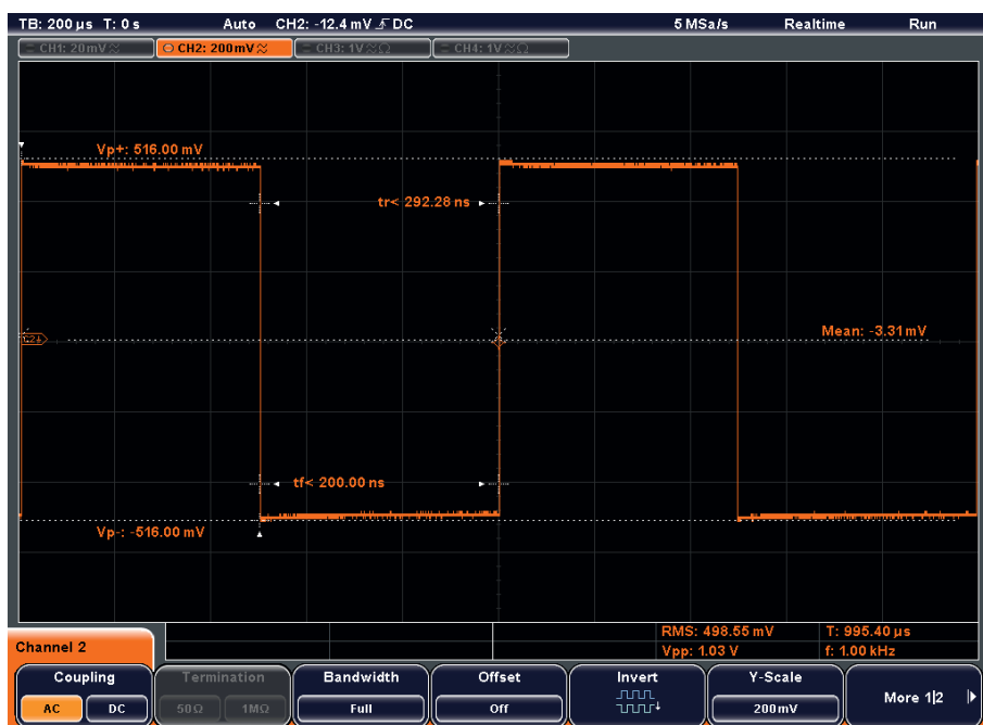
QuickMeas： 仅需一次按键，就可以自动测量并进行图形显示
