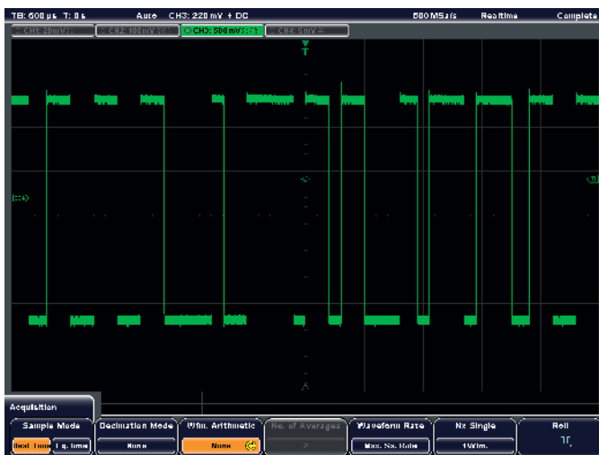
“平滑”模式可以对含有噪声的非周期性信号（左）进行平滑处理（右）。
