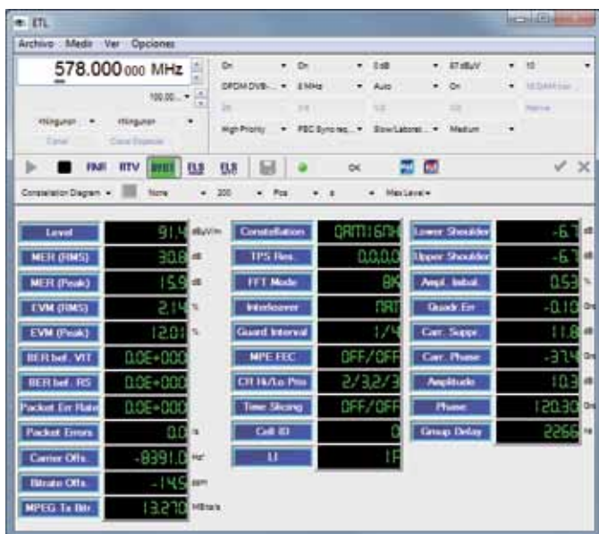
Ventana de diálogo para mediciones según pautas de UIT de una señal DVB-T.
