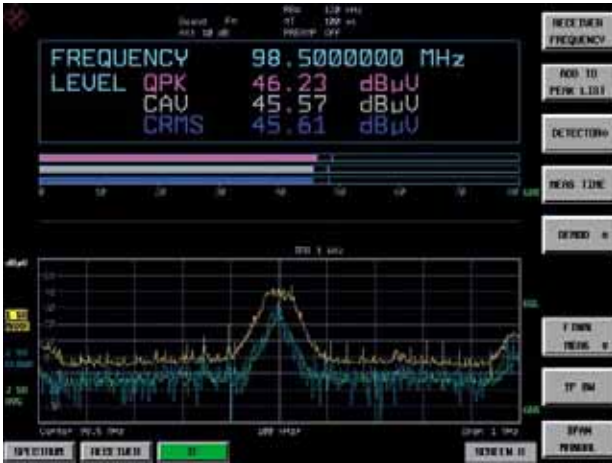
接收机模式（频率/电平显示、条形图显示和设定中心频率的连续实时IF分析）
