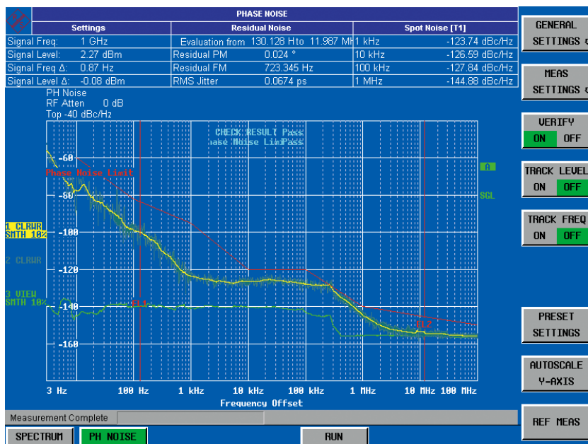
使用R&S®FS-K40应用程序进行相位噪声测量
