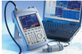
R&S FSHとPC間のデータ転送 (インタフェースとソフトウェアは本体に付属)
